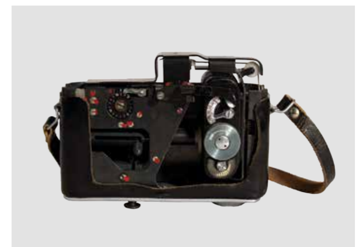
Appareil photo F-21 « Ajax » caché à l'intérieur d'un autre appareil photo pour prise de vue latérale clandestine (nom de code « UKOS »).
