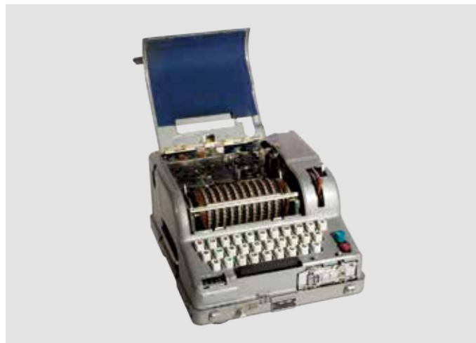
Rarissime machine de chiffrement/déchiffrement électro-mécanique à 10 cylindres, la « FIALKA » (URSS) permet de réaliser des communications cryptées.
