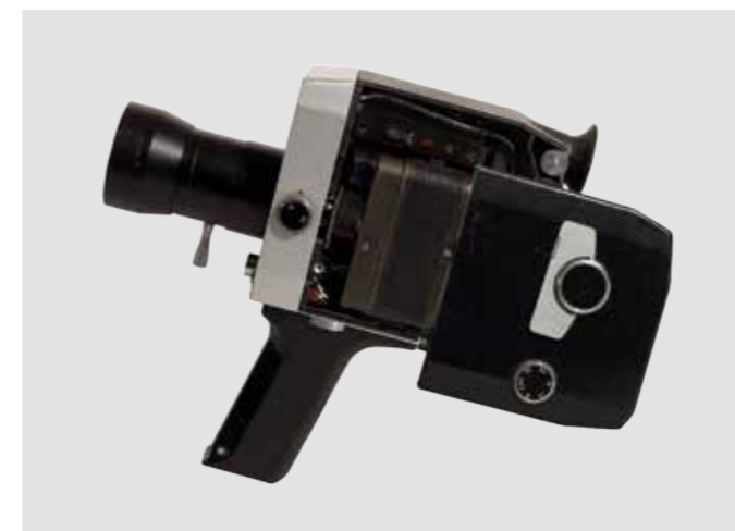
Camera KMZ « Quartz » 1x8 S-2 modifiée par le KGB (URSS), avec un appareil photo F-22 « NAILON » caché à l'intérieur et permettant la prise de photo clandestine à un angle de 90°.
