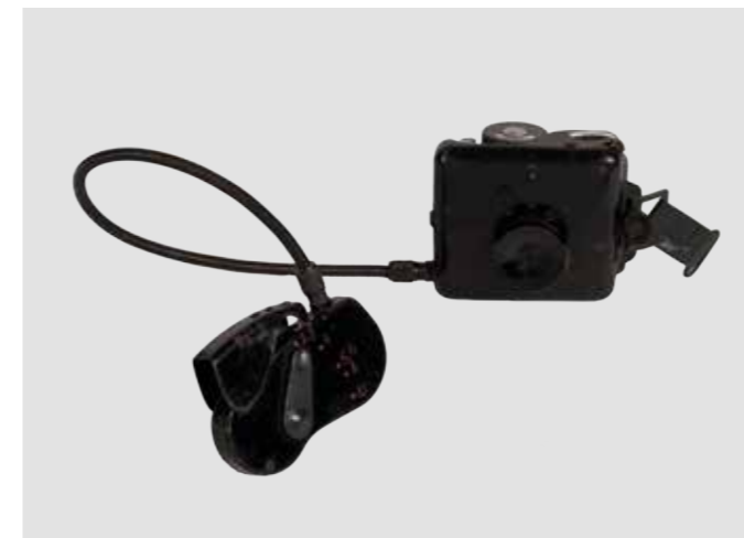
Appareil photo KMZ F-21 « Ajax » avec dispositif cache-bouton et déclenchement manuel. Produit à partir de 1951. L'objectif de l'appareil photo est masqué par le bouton qui s'ouvre transitoirement pour la prise de vue.
