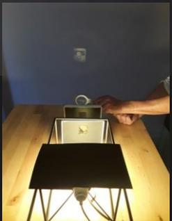
**Photographier l'objet , l'imprimer sur transparent et le fixer sur un support. Placer ce support sur le banc optique entre la source de lumière et la loupe. Déplacer la loupe afin d'obtenir une image nette sur le mur.**
