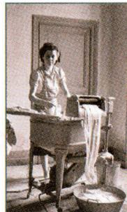
③ **Principe** : la manivelle pour brasser le linge est reliée par une courroie à un moteur électrique et tourne toute seule.
